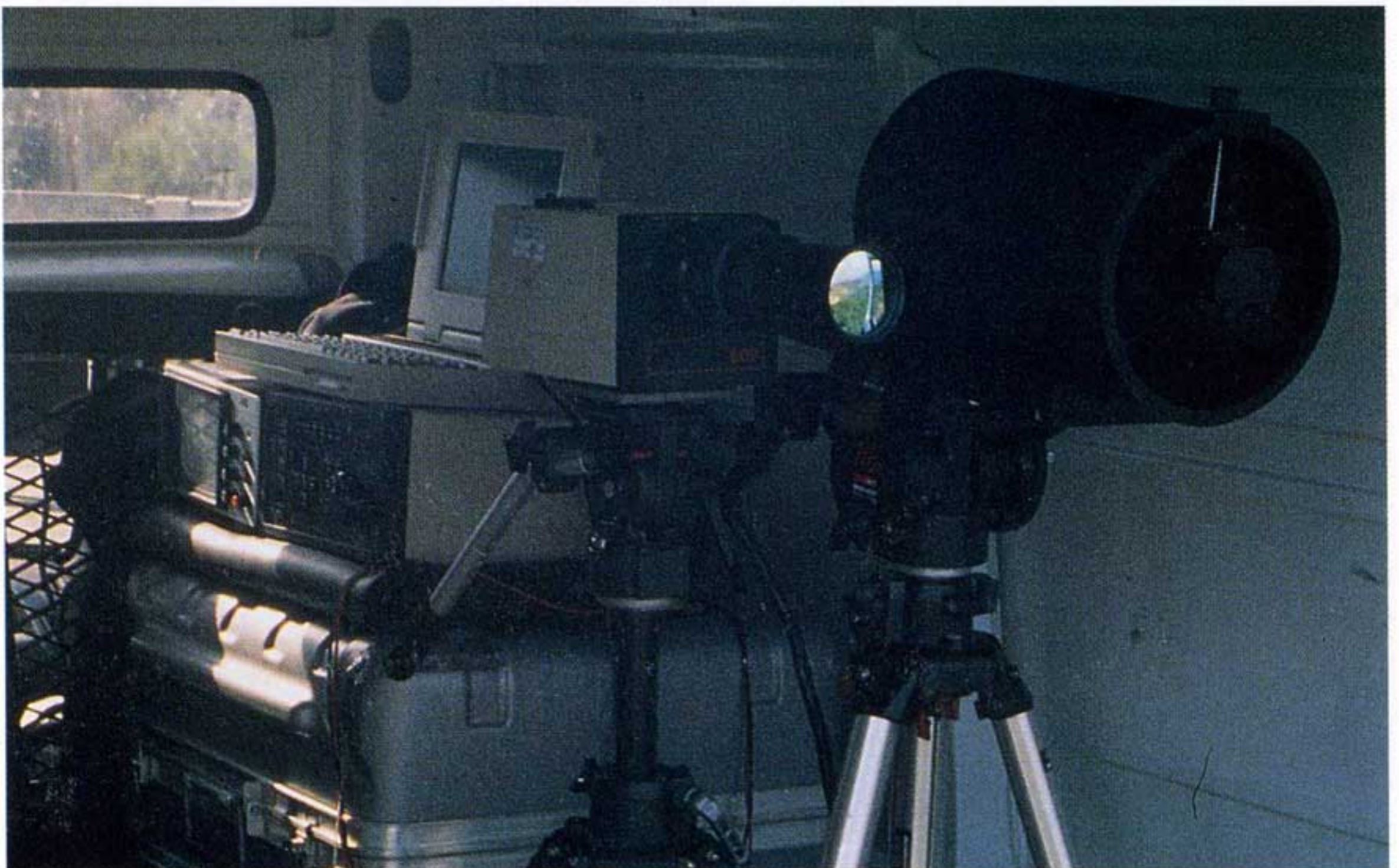
Foto 8 Primo piano del radiometro IR 8÷12 μm di produzione INFRAMETRICS
