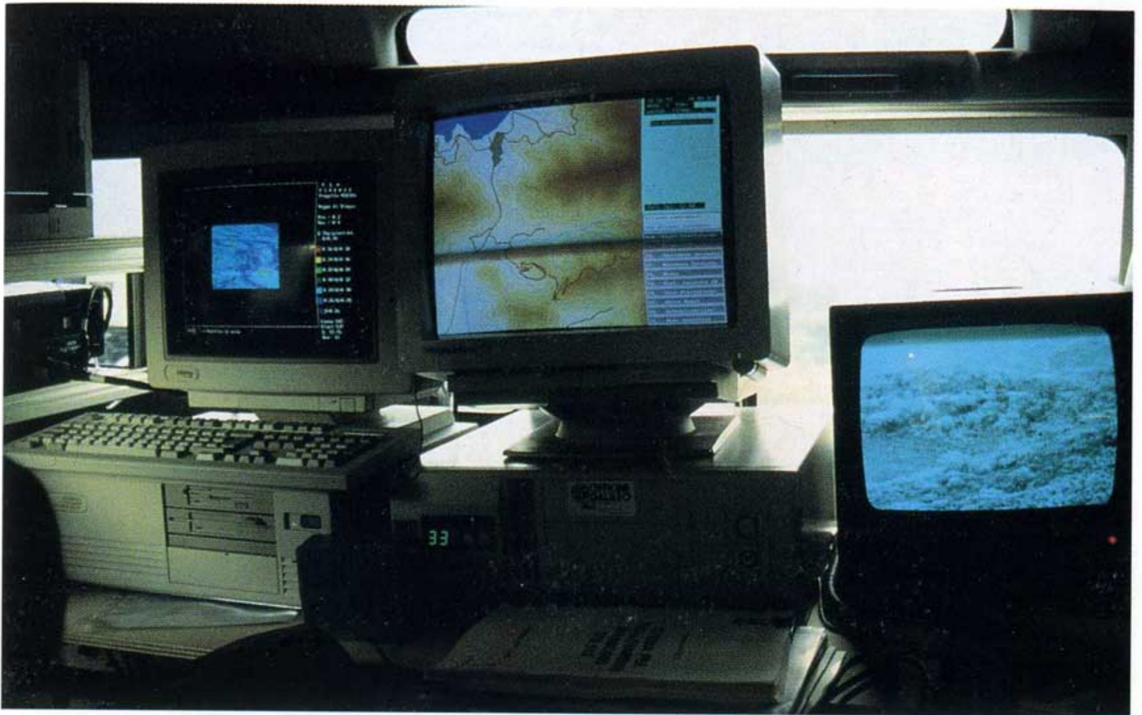
Foto 13 Consolle di lavoro del sistema MedSPA; sui primi due un monitor, relativi all'unità antincendio, è riprodotta l'immagine VIS e il DTM dell'area di Literno, mentre sul terzo la termografia della discarica
