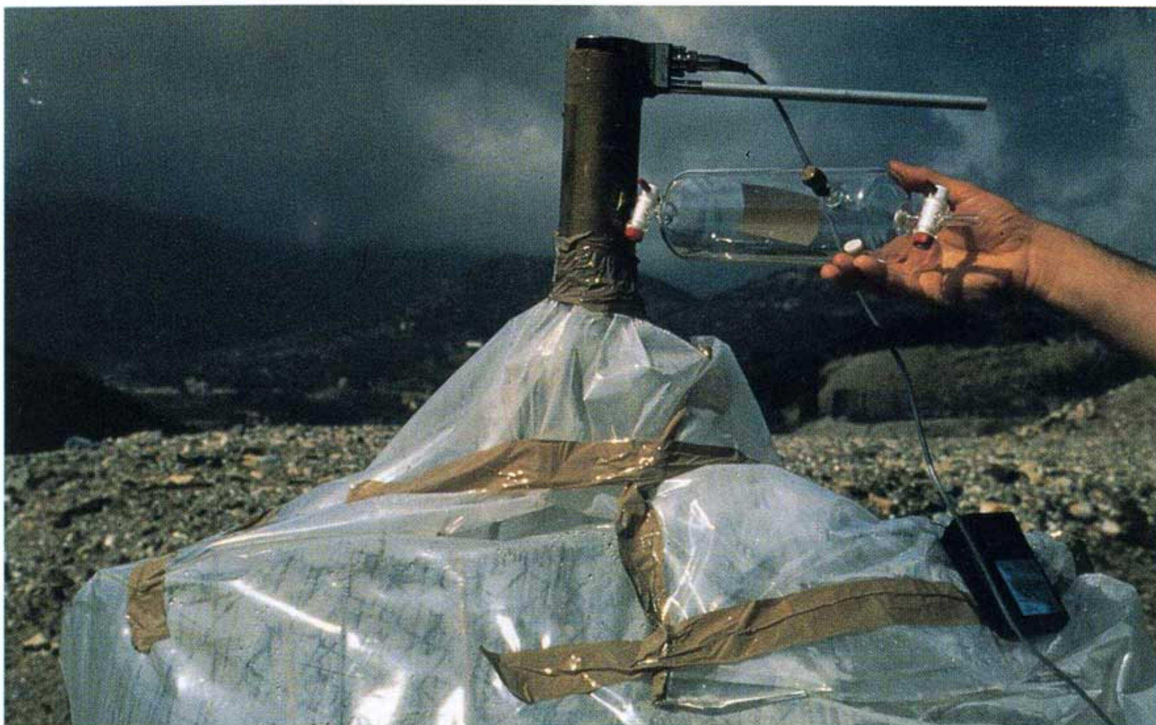
Foto 11 Prelievo di un campione del biogas da un camino di captazione per analisi chimica; nella foto si nota anche un multimetro per la misurazione tramite sonda della temperatura di efflusso del biogas
