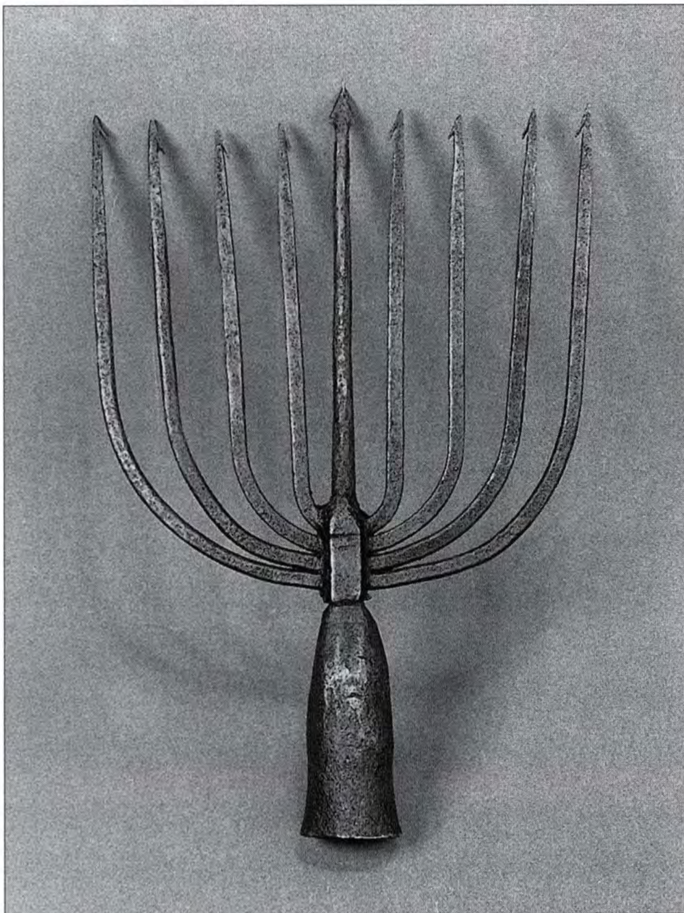
Fig. 76. Fiocina siciliana di estrema eleganza impiegata per la cattura di pesci di superficie ( fiocina da schiuma ) in particolare muggini. Di difficile impiego nella pesca dei polpi. (Dono di Enzo Papi - Baratti).
