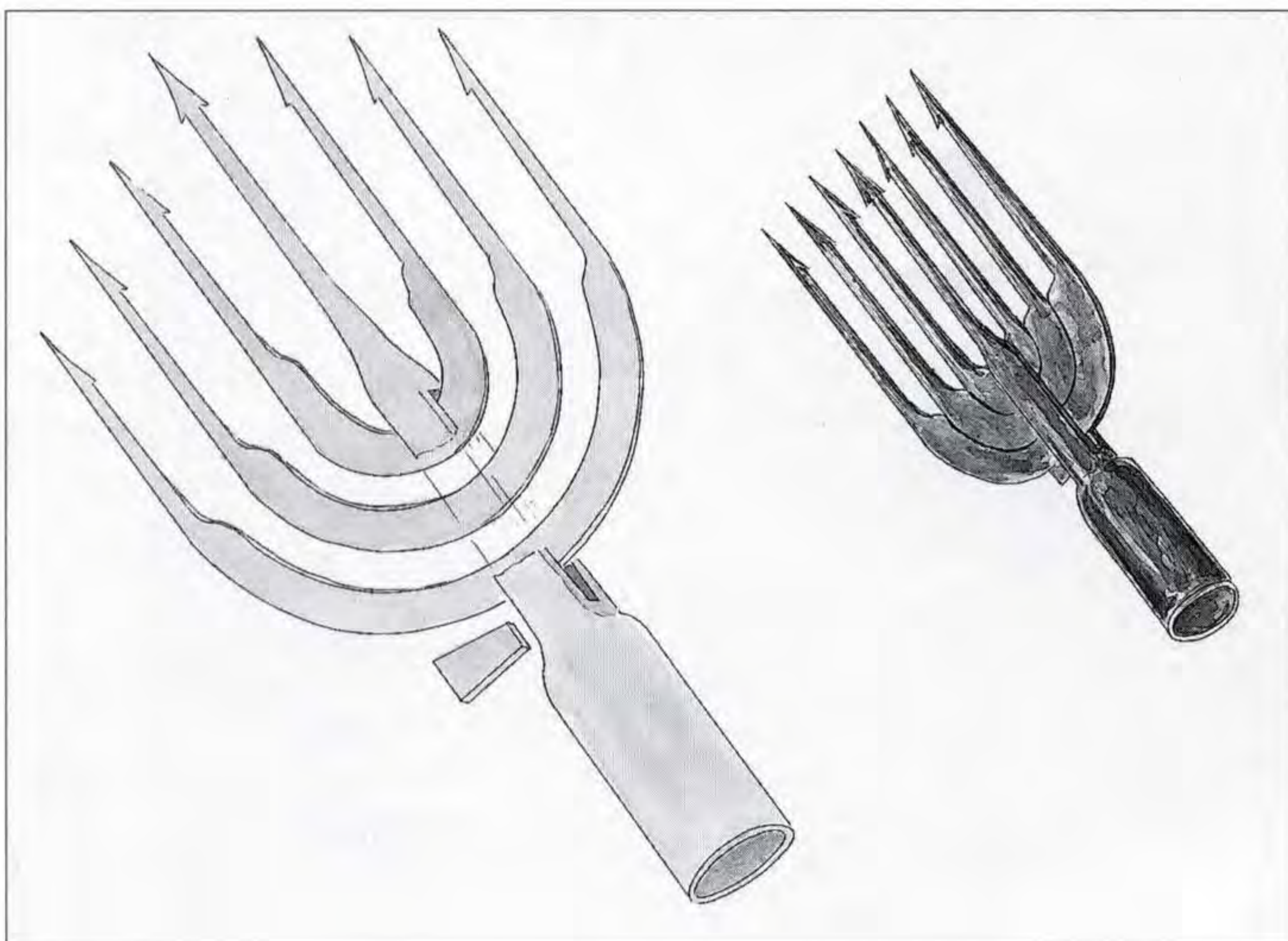
Fig. 10. Schema costruttivo della fiocina forgiata. Tale mestiere ormai abbandonato era conosciuto come fiocina napoletana .
