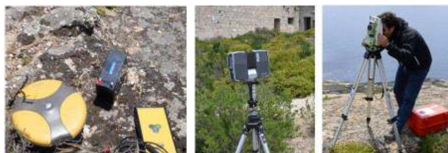
Fig.78 Rilievo GSNN, misura laser scanning, rilievo con stazione totale
