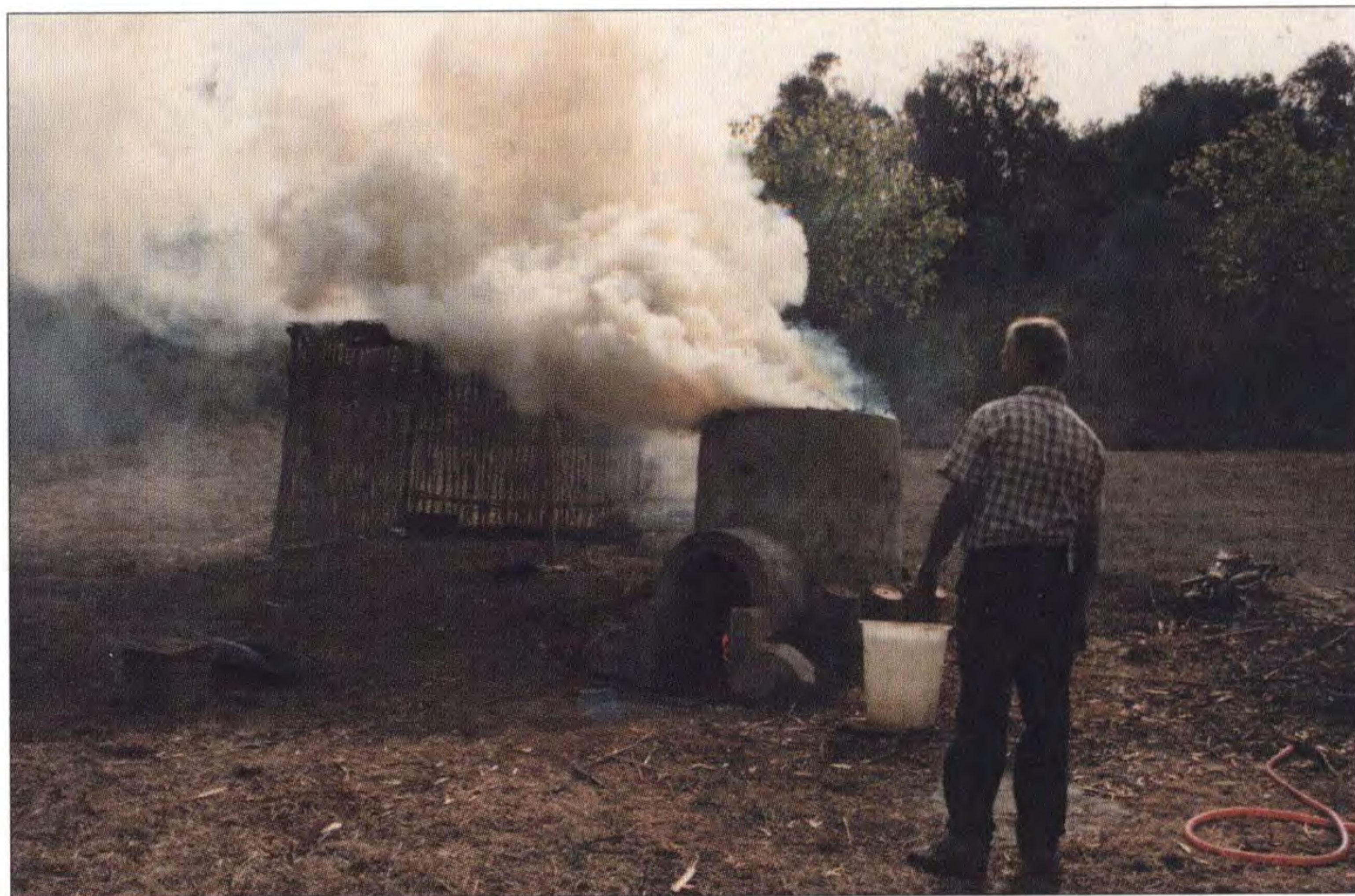
Fig. 47. Forno per la desolforazione della calcopirite, in funzione.
