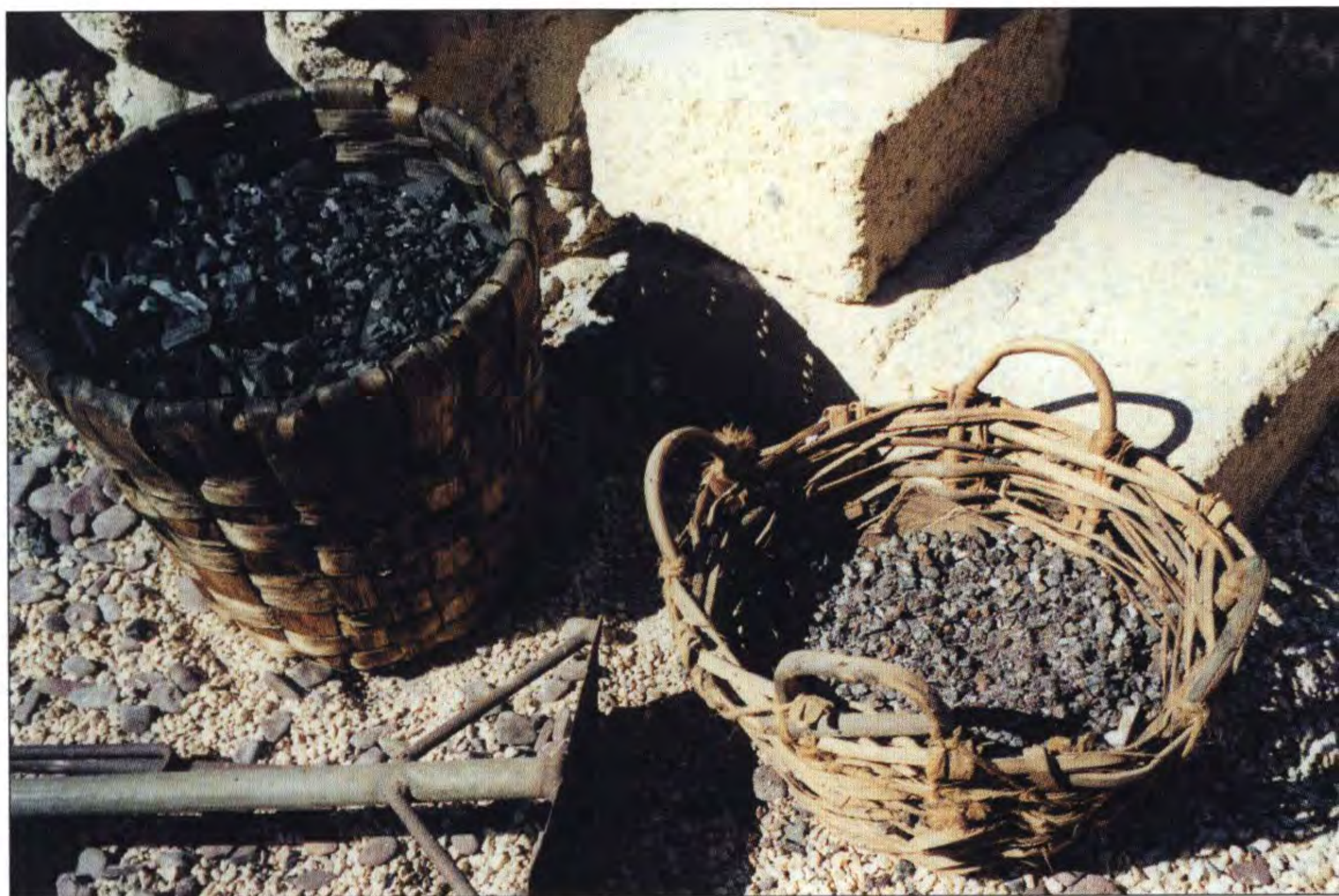
Fig. 38. Coffe contenenti carbone di legna (a sin.) e minerale di ferro: ematite (a des.) utilizzati per caricare un forno di riduzione per l'ottenimento del ferro.
