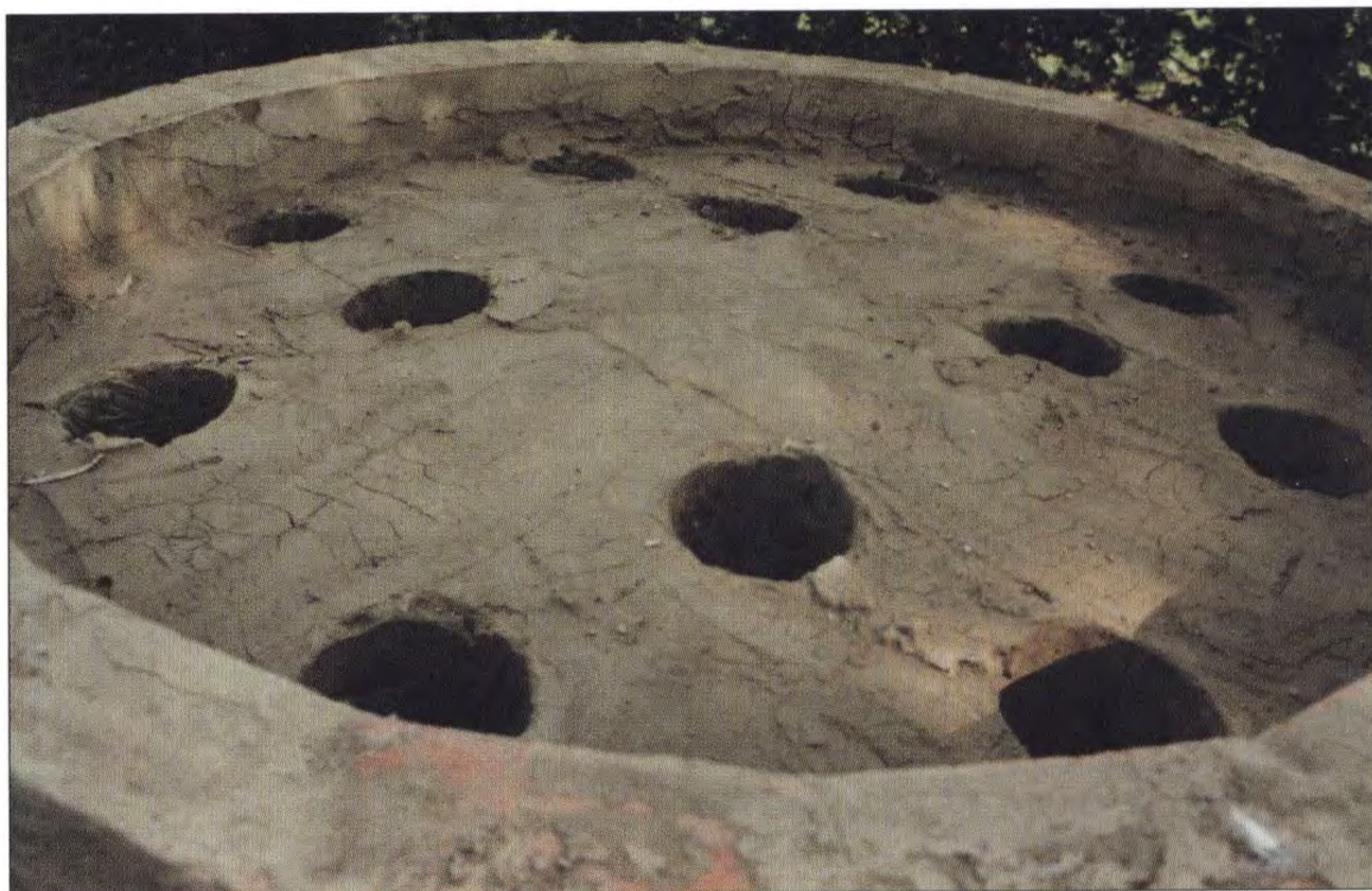
Fig. 46. Particolare di un setto forato di un forno, necessario per la desolforazione della calcopirite.
